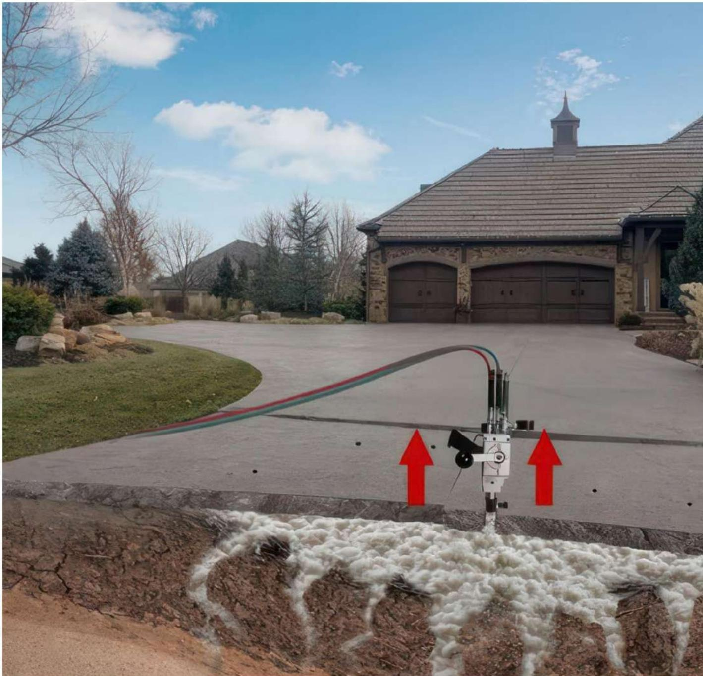
Pomocí technologie SlabLifting můžeme zvedat velmi hmotné stavební konstrukce v rekordně krátkém čase, bez prachu, hluku a vibrací.
